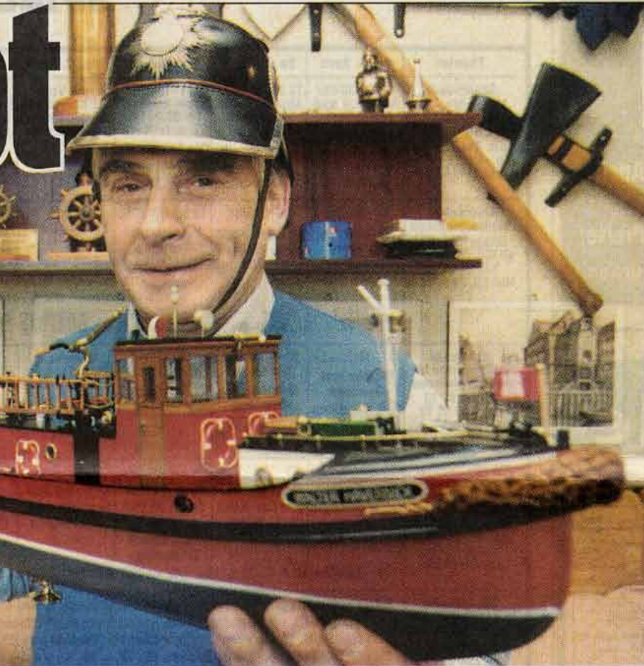
Harry am Ruder der „Walter Hävernick“, die früher als „Feuerwehr IV“, dann als „Oberbaurat Schmidt“ fuhr. 16,50 m lang, 26,5 t schwer, 120-PS-Diesel. Mit Branddirektor Manfred Gihl schrieb Harry sogar ein Buch: „Feuerwehr im Hafen“ (Kabel-Verlag). Beim Erhalt des Bootes helfen ihm viele Kollegen, z. B. Karl Wintzensen, Herbert Saß, Hans Lefs usw. Das zu erwähnen liegt Harry besonders am Herzen.
