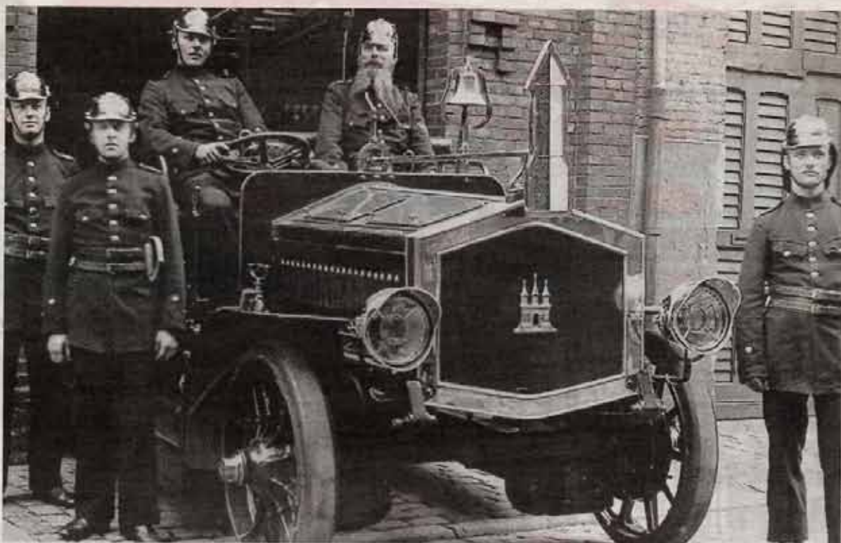
Um 1912: Mit einem überdimensionalen „Winker“ (Fahrtrichtungsanzeiger) vor der Köhlerhaube war diese Autospritze ausgestattet
